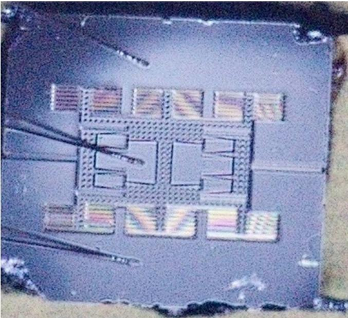
Fig. 3. MEMS-accelerometer sensor element.
