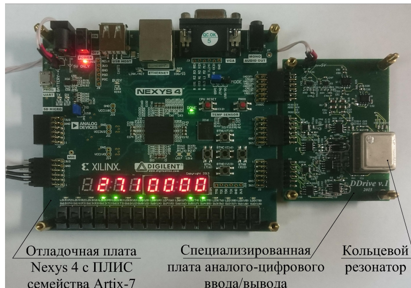
Рис. 4. Изготовленный макетный образец МЭМ-гироскопа с кольцевым резонатором и цифровой электронной подсистемой
