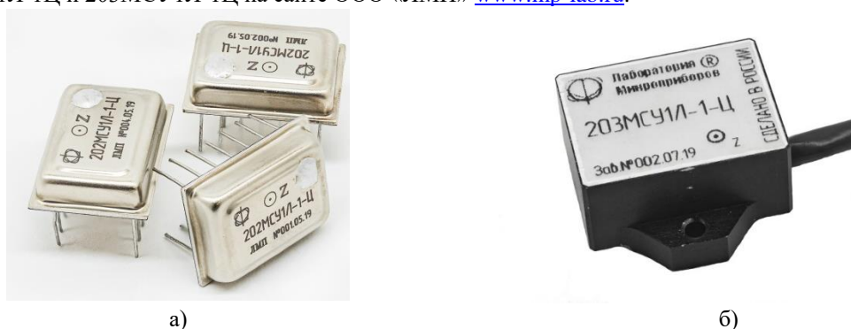
Рисунок 1 – Микромеханический акселерометр: а) серия 202МСУ1Л-1Ц; б) серия 203МСУ1Л-1Ц.
