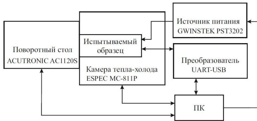
Рисунок 6 – Структурная схема разработанного автоматизированного стенда
