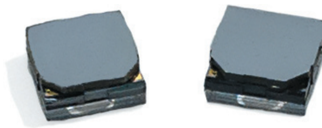
Рис. 3. Фотография микромеханических датчиков удара
