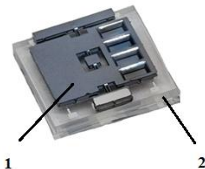
Рис. 1. Разработанный чувствительный элемент МЭМС-акселерометра: 1 – инерционная масса, 2 – стеклянная пластина с напыленными электродами
