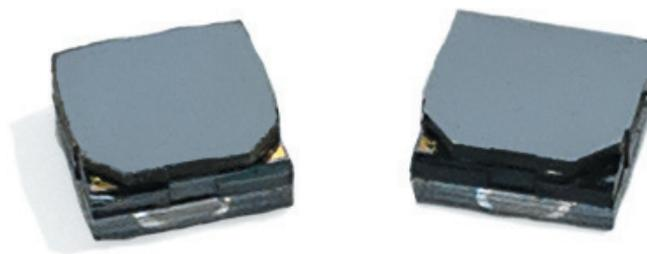
Рис. 3. Фотография микромеханических датчиков удара
